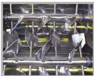
Foto 5. Es imprescindible la limpieza y mantenimiento de todos los equipos que componen la instalación de adición Post Pelleting. Interior de un BATCH Coater
