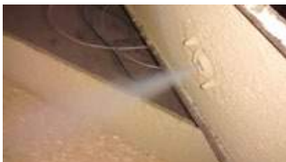
Foto 4. Los aditivos líquidos deben siempre aplicarse nebulizados para lograr su distribución homogénea sobre todos gránulos fabricados
